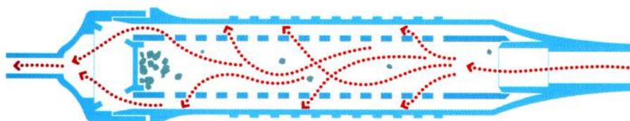
*Il sistema brevettato di flussi incrociati permette ai fluidi di passare subendo danni minimi trattenendo frammenti che occluderebbero i set di aspirazione convenzionali*
