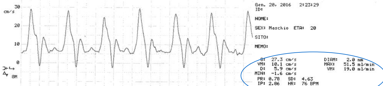
Rappresentazione numerica precisa e ripetibile della velocità del flusso ematico cm/sec e della portata del flusso ml/min
